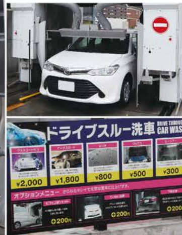
洗車機の前に専用ゲートを組み噴射ノズルを搭載することで、“魅せる”泡洗車を実現した泡洗車システムとドライブスルー洗車機。洗浄からワックス・コーティング、乾燥(右上)までを自動で行う。
