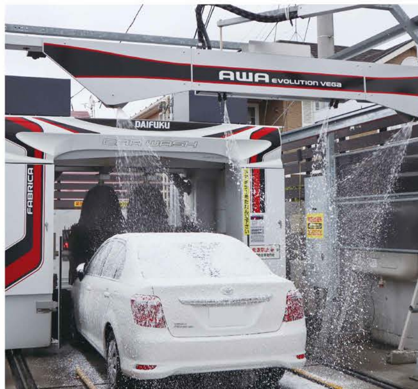
洗車機の前に専用ゲートを組み噴射ノズルを搭載することで、“魅せる”泡洗車を実現した泡洗車システムとドライブスルー洗車機。洗浄からワックス・コーティング、乾燥(右上)までを自動で行う。
