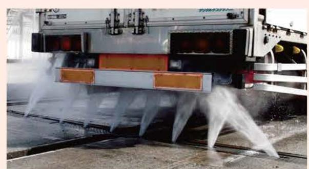
高圧水を強力に噴射する自走式の下部洗浄装置
