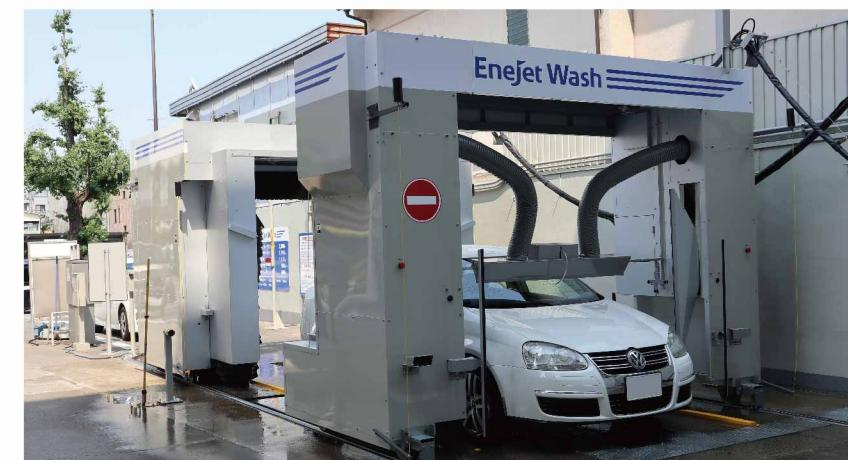
洗浄機(左)と乾燥機(右)が分離しているので、洗浄中に乾燥を開始できる。
