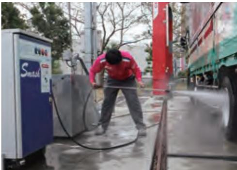
レール横に設置した高圧洗浄機。洗車前に下回りを予備洗浄することで、より効果的な洗車が可能。
