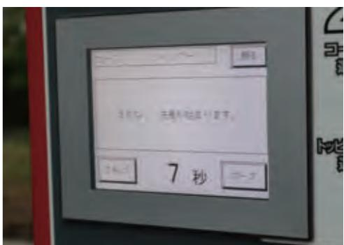
液晶タッチパネルは、稼働状況の表示、エラーメッセージの確認やメンテナンスの設定が行える。
