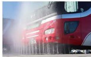
土間固定式の下部洗浄装置。高圧水で底面の汚れを洗い落す。
