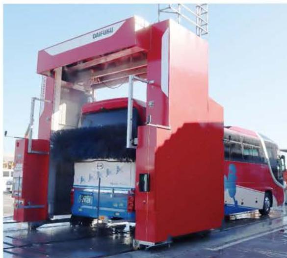
大型洗車機「カミオン カスタム」。リヤ部も強力かつスピーディに洗浄できる。
